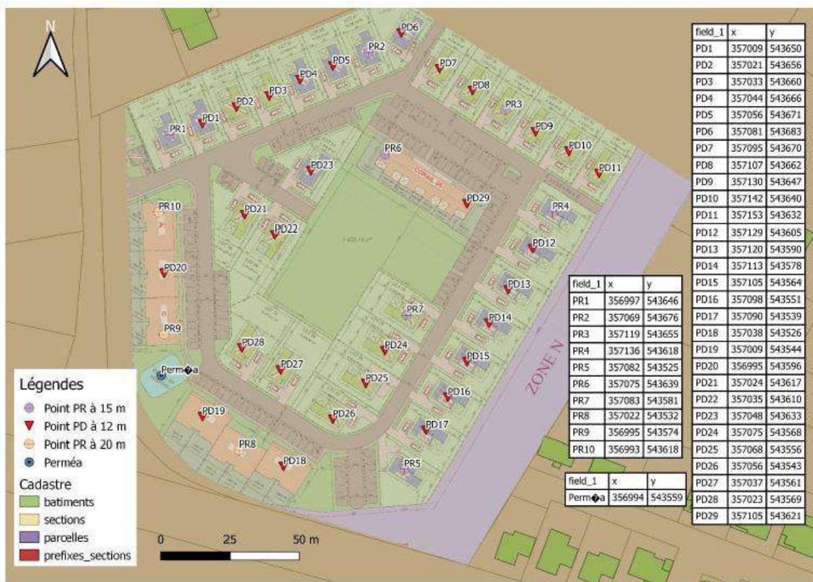
Figure 14 : Implantation des sondages géotechniques
